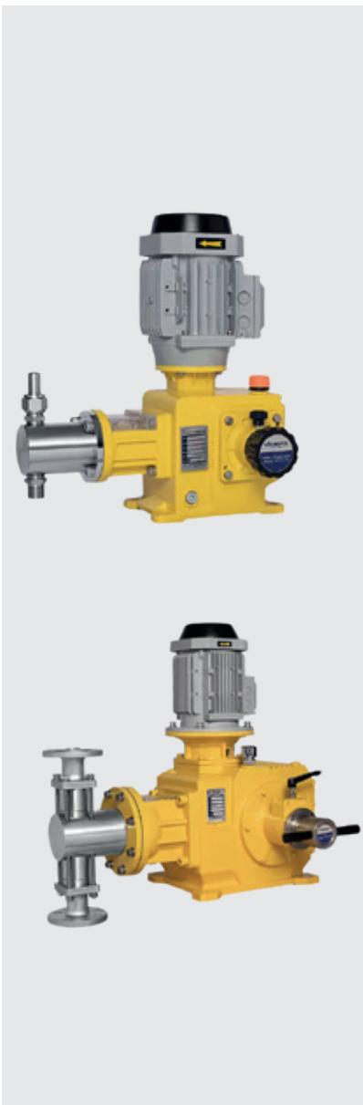
Принцип действия плунжерного дозировочного насоса заключается в перемещении поршня с образованием разрежения или сильного давления. При разрежении система всасывает жидкость, при нагнетании — выталкивает ее.
