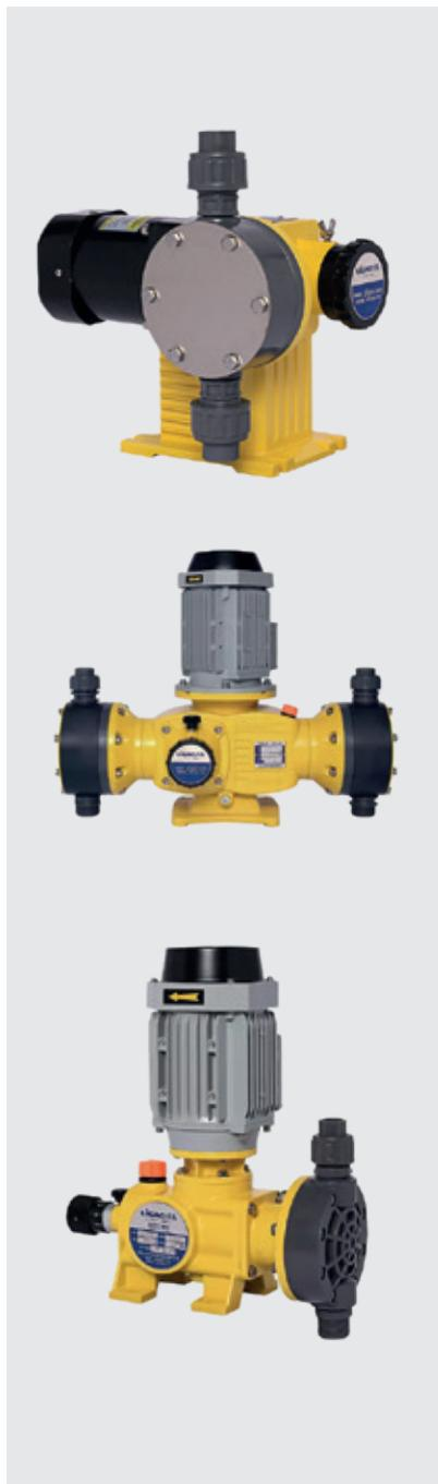
Механические дозировочные насосы – это мембранные насосы с асинхронным двигателем. Мембрана представляет собой пятислойную композитную диафрагму из PTFE с усиленной задней пластиной. Для изменения производительности можно менять как длину хода вала, так и частоту. Насосы этого ряда отличаются простой, надежной конструкцией и выгодной стоимостью, являясь примером, того как универсальное дозирование может сочетаться с минимальным техническим обслуживанием
